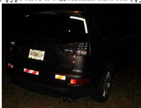
Световозвращающие наклейки на автомобиле и мотороллере
