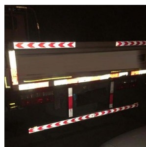
Детская коляска и седельные тягачи со световозвращающими наклейками (сзади и сбоку на полуприцепе)
